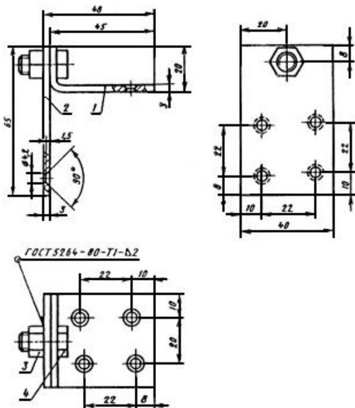
1 - угольник; 2 - пластина; 3 - гайка М8 по [ГОСТ 5915-70](#); 4 - болт М8х14 по [ГОСТ 7805-70](#)
